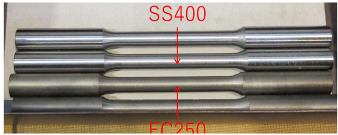
図 8 完成した引張試験片
