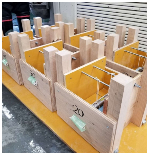
写真-2 コンクリート供試体型枠
