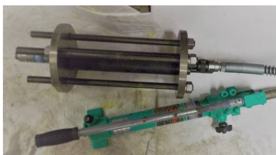
図-4 耐圧実験装置1号機外観
