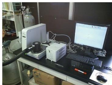
写真-2 示差走査熱量分析装置
