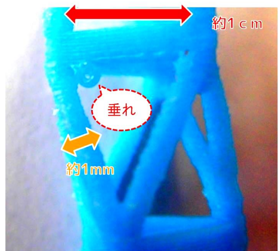
図-4 支持材不使用の橋渡し造形
