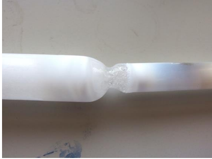
図-3 異径管接合部
