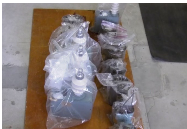
写真 12 選別後の非PCB含有機器
