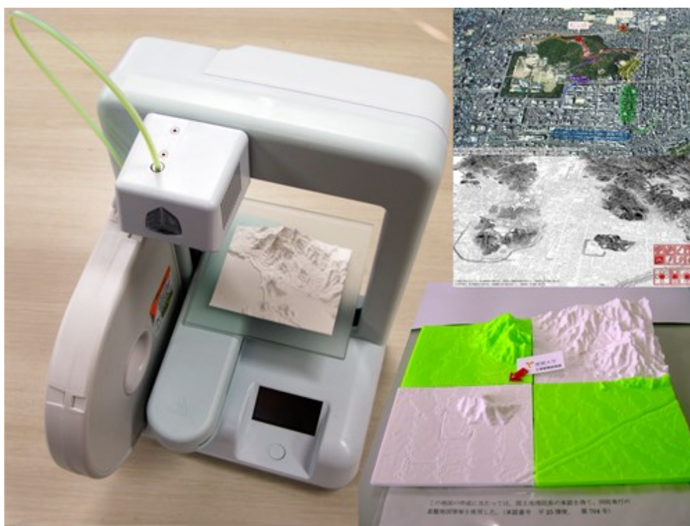
写真-1 3Dプリンターと標高データを利用し作成した地形模型、および自作の地図ソフト
