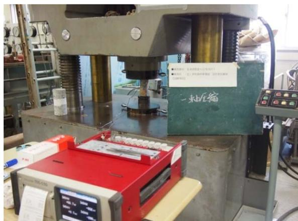
写真－7 圧縮強度試験とひずみの測定
