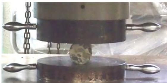
写真-12 コアの割裂载荷
