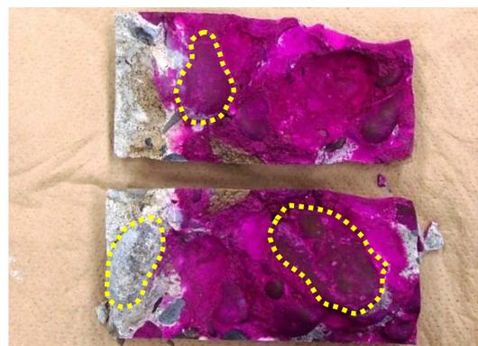
写真-14 粗骨材の含有状況
